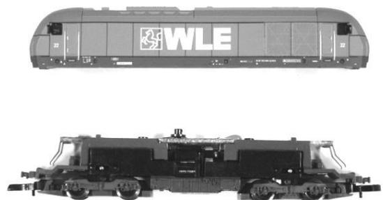
2. Legen Sie das Lokchassis so vor sich, dass sich der Entstörkondensator rechts vom Motor befindet.
