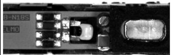
5. Sicherstellen, dass die Lichtkontakte des Decoders die Kontaktflächen an beiden LED-Platinen der Lok korrekt und möglichst jeweils in der Mitte berühren.
