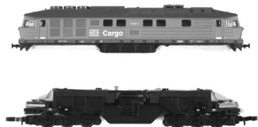
2. Legen Sie das Lokchassis so vor sich, dass sich der Kondensator rechts vom Motor befindet.
