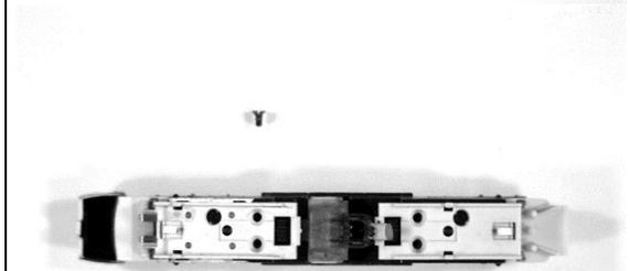
4. Jetzt die kleine Senkkopfschraube in das Gewinde der großen Schraube direkt daneben hineinschrauben.
