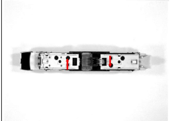
5. Lokdecoder einsetzen, dabei auf die korrekte Einbaurichtung achten. Der Entstörkondensator der Lok muss im Ausschnitt des Lokdecoders sitzen. Die beiden mitgelieferten Schrauben durch die Löcher im Lokdecoder in die Gewinde im Lokrahmen schrauben.
