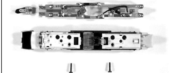
3. Die kleine Senkkopfschraube, die sich entweder oben rechts oder unten links vom Motor befindet, ebenfalls herausdrehen.
