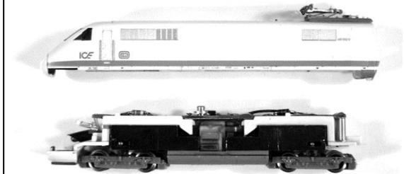
2. Beide schwarze Schrauben herausdrehen, die Lämpchen herausziehen und die Leiterplatte abnehmen.
