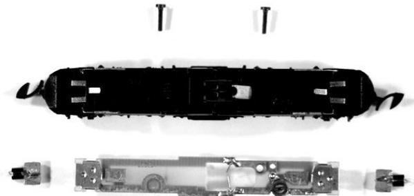
3. Lokdecoderplatine so herum bereitlegen, dass die Öffnung im Decoder auf gleicher Höhe liegt wie der Motorkollektor bzw. der Entstörkondensator.
