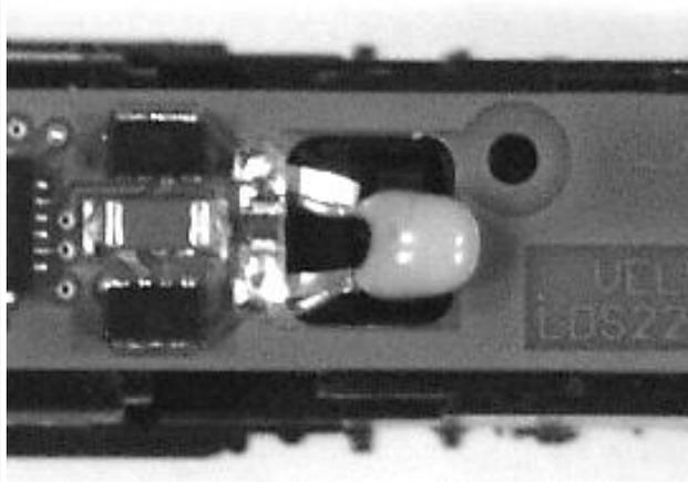
5. Die beiden mitgelieferten Schrauben durch die Löcher im Lokdecoder in die Gewinde im Lokrahmen schrauben.
