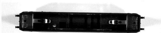
7. Vor dem Schließen des Lokgehäuses sicherstellen, dass die Motoranschlüsse keine Teile des Lokrahmens berühren oder kurzgeschlossen sind.
