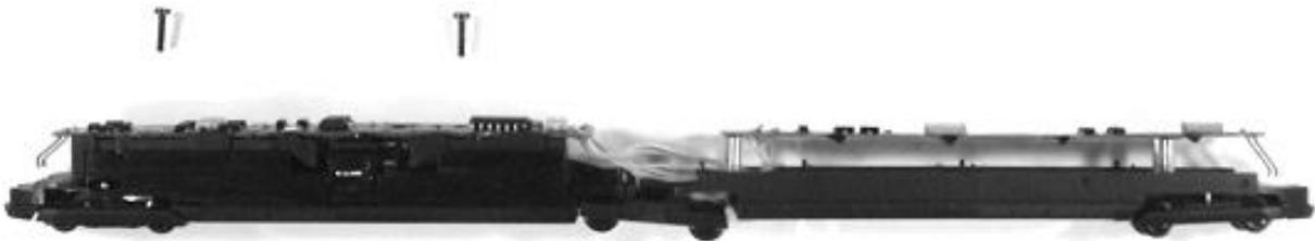
5. Wichtig ist die Lage der Motoranschlussdrähte. Sie müssen die beiden Entstörkondensatoranschlüsse berühren und dürfen gegeneinander keinen Kurzschluss bilden.
